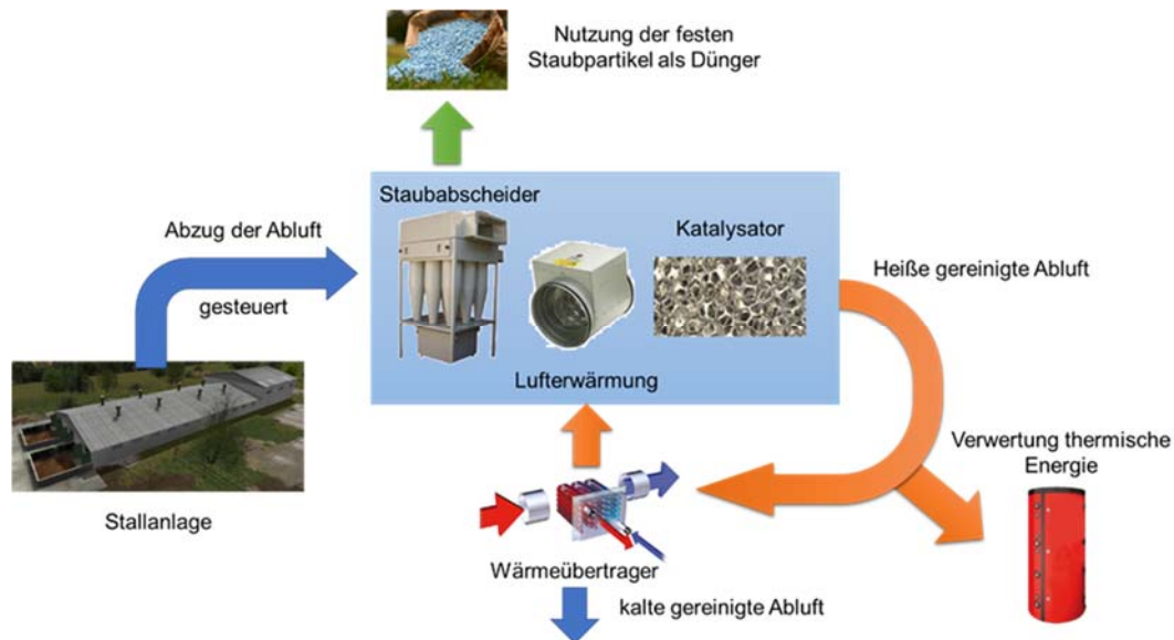
Abb. 1: MIST - Entwicklung eines Reinigungssystems für Abluft zur Beseitigung störender Gerüche, Ammoniak-Emissionen und Staub aus Stallanlagen
